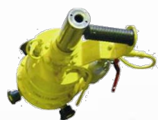
УКД-1 для консерв. топл. сист. двигателя
