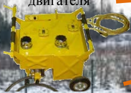
УКД-1 для консерв. топл. сист. двигателя
